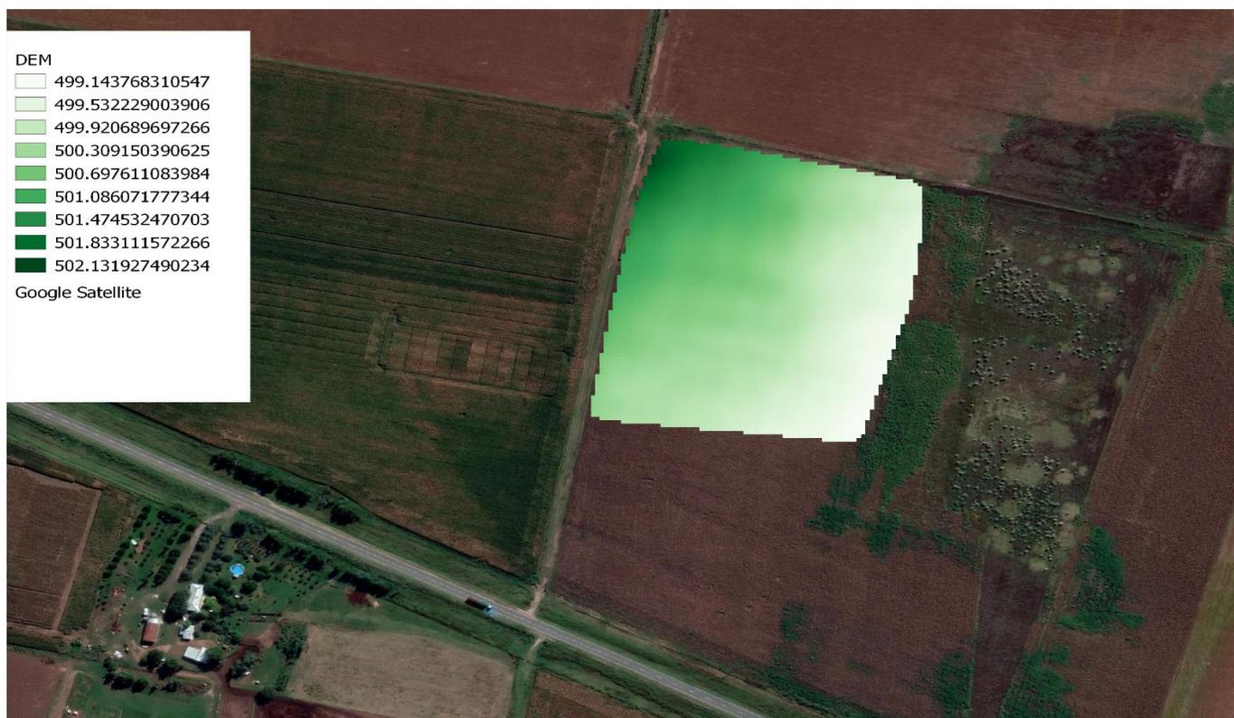
En la Foto 1 se puede apreciar el mapa digital de elevación realizados por Servicios Tecnológicos de AGD en invierno de 2019. Se puede observar que el lote presenta un relieve norma muy suavemente ondulado con una cota mínima de 499,1 m y máxima de 502.1 m (3 m de desnivel, 1,15% de pendiente).
